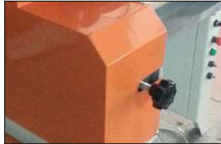
Kağıt boru çapına göre ileri geri ayarlanabilir / Paper tube position adjustable according to paper tube diameter
