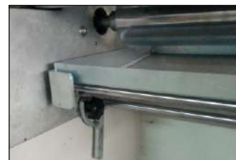
Yüksekliği ayarlanabilir ve çıkarılabilir tutkal tavası / Height adjustable and detachable glue bucket
