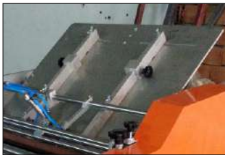
Genişliği hassas ayarlanabilir besleme tablası / Precision adjustable feed table to label width
